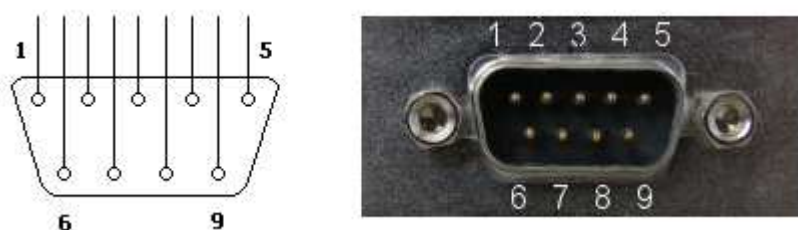
Obr. 5: Schematická značka a ukázka v záslepce PC konektoru Cannon 9
