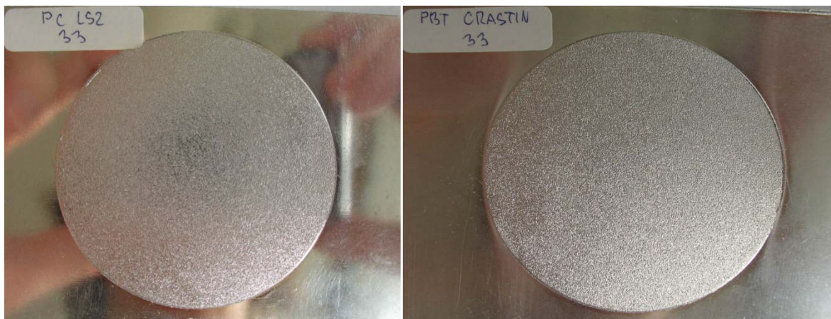
Obrázek 2. Srovnání dvou odrazných povrchů různých materiálů PC LS2 33 a PBT Crastin 33 obráběných stejným elektrickým proudem.
